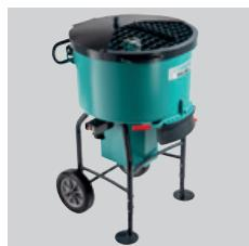
Model za veći volumen miješanja (120 litara). Robusna izvedba sa čeličnom posudom. Alat s 3 kraka za intenzivno miješanje; letvica koja se povlači za otvaranje vrećica; isput na dnu i naprava za vibraciju radi lakšeg pražnjenja, priključak za usisavanje prašine, jednostavno čišćenje.
