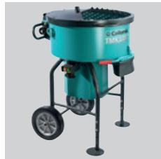
Jedinstvena primjena za mnoge zapakirane materijale. Robusna izvedba sa čeličnom posudom. Alat s 3 kraka za intenzivno miješanje; letvica koja se povlači za otvaranje vrećica; isput na dnu i naprava za vibraciju radi lakšeg pražnjenja, priključak za usisavanje prašine, jednostavno čišćenje.
